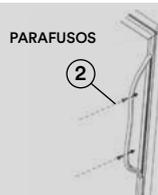
3. Aperte os parafusos usando uma chave de fenda até que a maçaneta fique alinhada e esteja firmemente presa contra a moldura da porta. Atenção: NÃO aperte demais, pois isso causará danos à montagem da alça.
