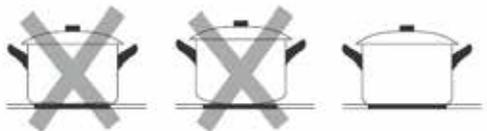
Se a base do recipiente for apenas parcialmente ferromagnética, apenas a área ferromagnética aquecerá. Isto pode significar que o calor não será distribuído uniformemente. A área não ferromagnética pode não aquecer a uma temperatura suficiente para cozinhar.
