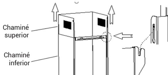
3. Faça furos de 2 x 8 mm para acomodar a placa II. Aparafuse e aperte a placa II na parede com os 2 parafusos fornecidos. Monte a chaminé no móvel e fixe-a com 2 parafusos.
