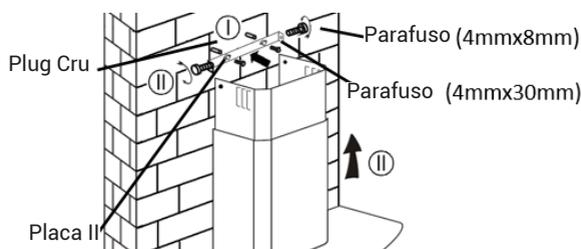
**Aviso:** Deixar de instalar os parafusos ou o dispositivo de fixação de acordo com estas instruções pode resultar em acidentes elétricos.
