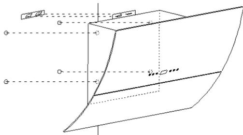
3. Deixe o exaustor levantado e pendure no gancho de suporte de parede
