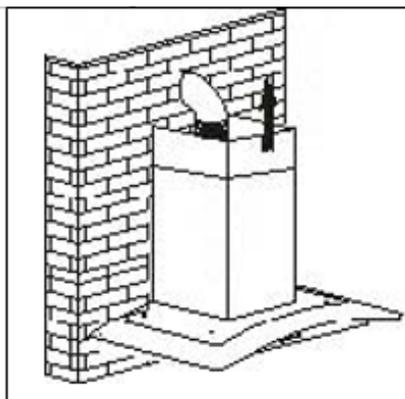
2. Deslize a chaminé para ajustar a sua altura. Quando a altura desejada for atingida, pendure o orifício de fixação nos parafusos de fixação conforme mostrado nas fotos abaixo.
