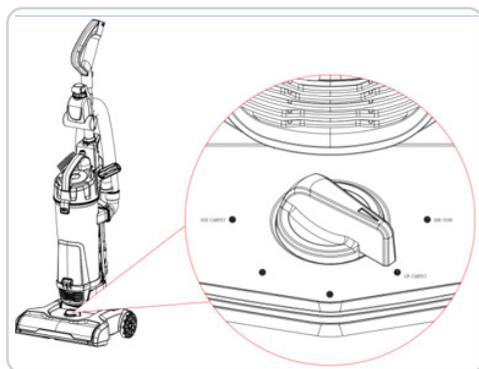
A unidade possui cinco ajustes de altura para diferentes tipos de piso, por exemplo, piso duro, tapete baixo, tapete alto e assim por diante. Ao ajustar a altura da unidade, a máquina está na posição vertical.
